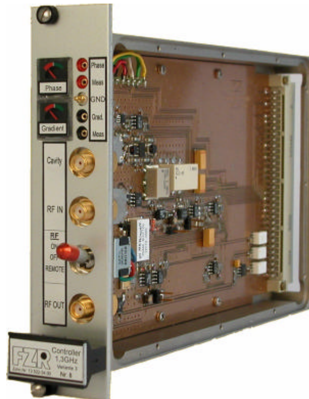
Abb. 5 Ansicht des HF-Reglermoduls
