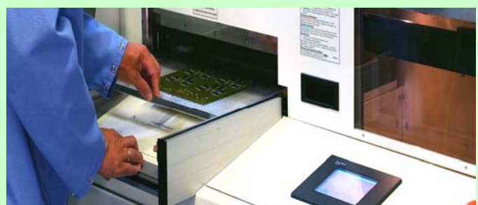
Nach Abkühlen hinter Ladetür kann Baugruppe entnommen werden.
