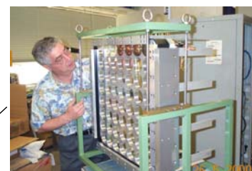
Einbau der PMTs
