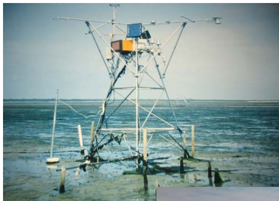
Messstation im Wattenmeer List (Sylt) hoch präzise Temperaturmessung
