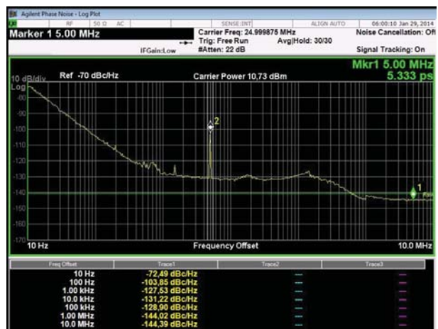
Abbildung 4. Phasenrauschmessung des Master-Taktes mit dem Signalanalysator Agilent PXA N9030A
