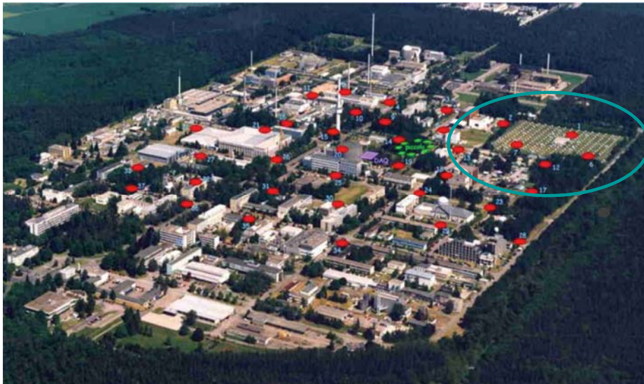
700 x 700 m 2 , 37 Detektoren, Abstand 130 m, bis 10 18 eV
